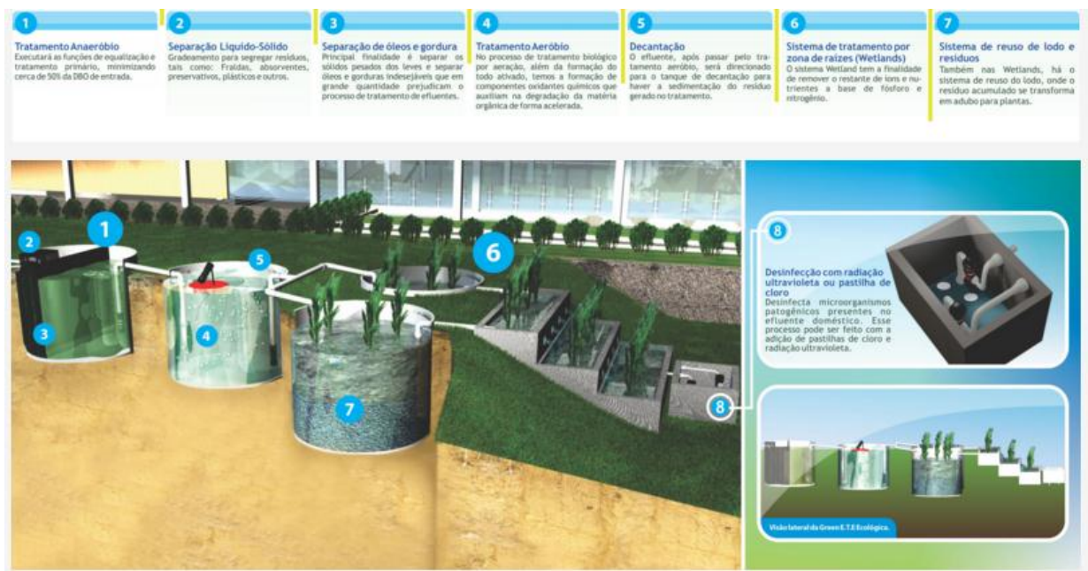
Figura 62: Estação de tratamento ecológica Ecobox-Bio.
