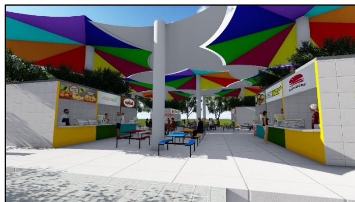
Figura 74 Cobertura da praça de alimentação do parque em lona tensionada Fonte: Produção da autora
