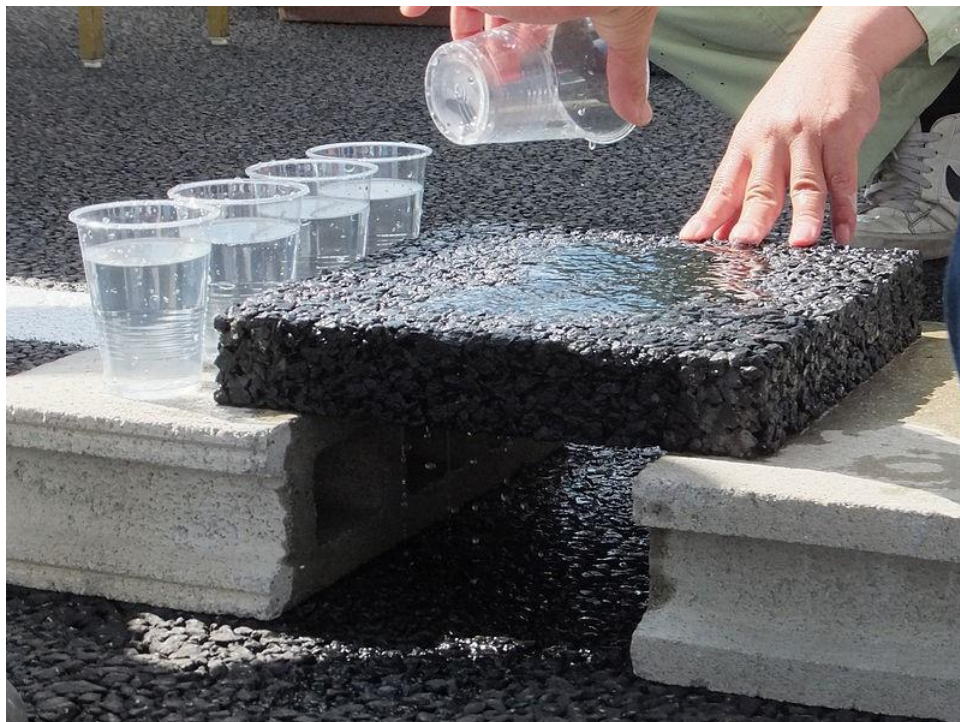
Figura 26 - Demonstração da absorção de revestimentos porosos.
