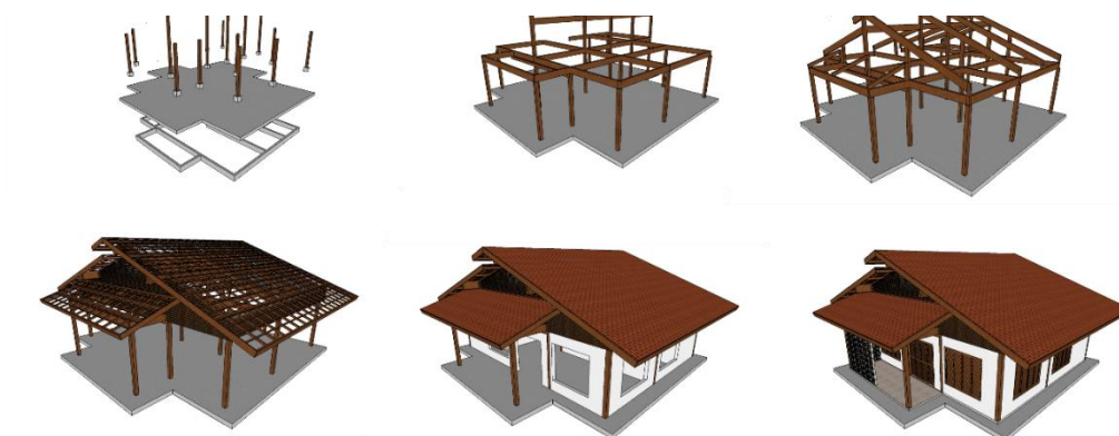
Figura 70 - Sistema Construtivo da Residência Modelo.
