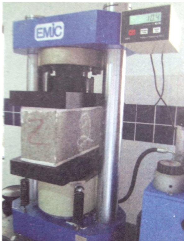
Figura 23 - Realização da resistência à compressão. Fonte: Idário Fernandes (2013).
