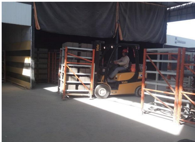
Figura 19 - Prateleiras de blocos sendo transportadas para as câmaras de cura. Fonte: Elaborado pelo autor.
