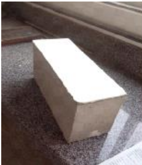
Figura 22 - Bloco capeado. Fonte: Manual de produção de bloco da empresa Comblocos. Gabriela Lustosa (2016).
