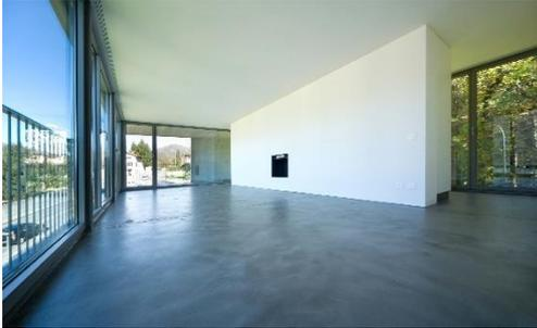
**Piso cimento queimado:** Simples de ser executado, feito a partir de argamassa, misturada com cimento, areia e água. A argamassa deve ser aplicada com uma espessura aproximadamente de 30mm sobre o piso. É vantajoso em caso de reformas, disponíveis em várias cores.
