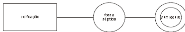
Figura 49: Sistema de fossa séptica e sumidouro Fonte: Código de Obras e Instalações do Município de Macapá (2004, p. 66)
