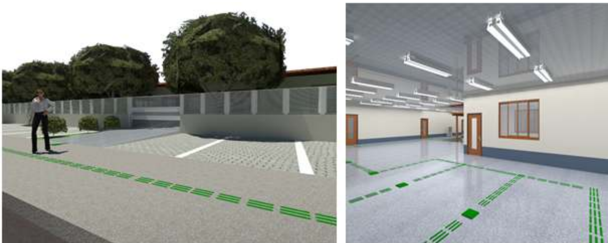
Figura 60: Vista frontal e do interior da edificação com sinalização de piso tátil
