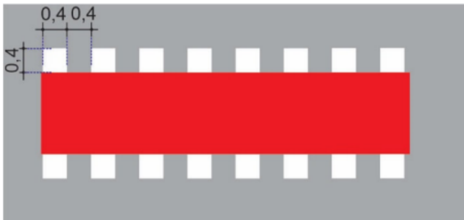
Figura 22 - Ilustração da marcação de cruzamento rodociclovitário.
