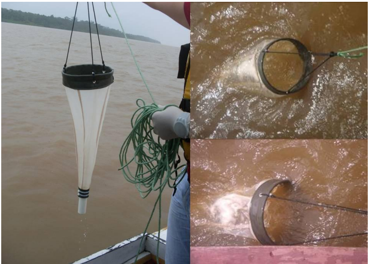
Figura 2: Rede para a coleta de fitoplâncton e método de amostragem (arrasto)
