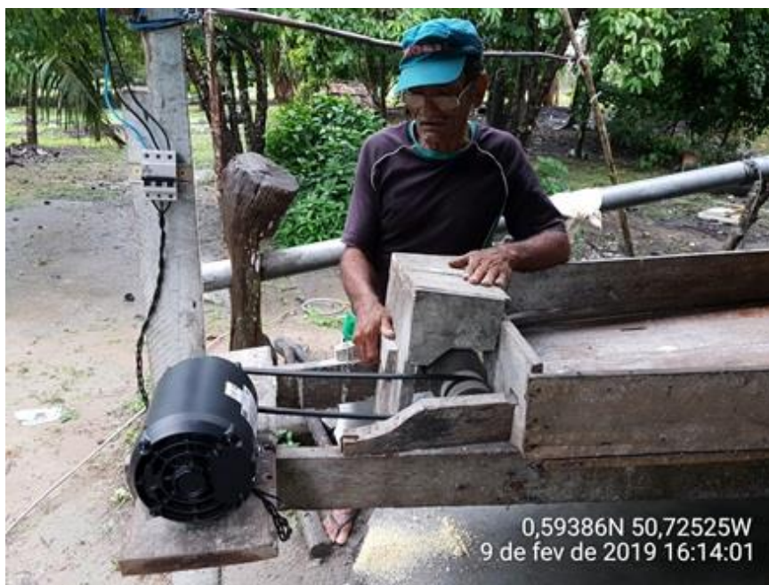
Figura 18 – Ralador de mandioca após a substituição do motor à gasolina por um motor elétrico.
