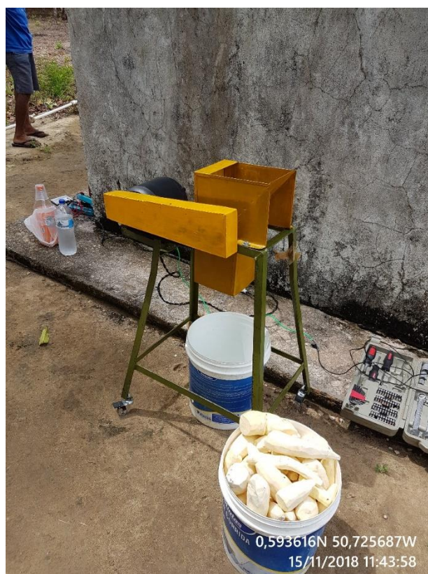
Figura 27 – Instalação do ralador de Mandioca de ½ CV na propriedade agrícola.
