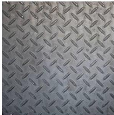
Figura 60 – Chapa de aço para o mezanino.
